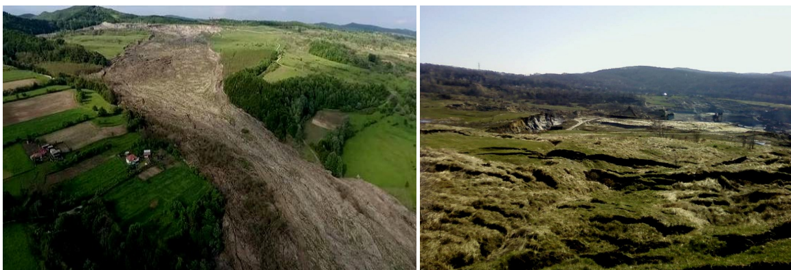
Fig. 4. Alunecarea haldei exterioare Berbești Vest (stânga) și alunecare prin corpul haldei interioare Panga (dreapta)
